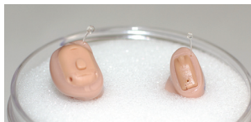
耳あな形補聴器を音の出口を下にして穴に挿し込むことで、乾燥効果がより高まります。
